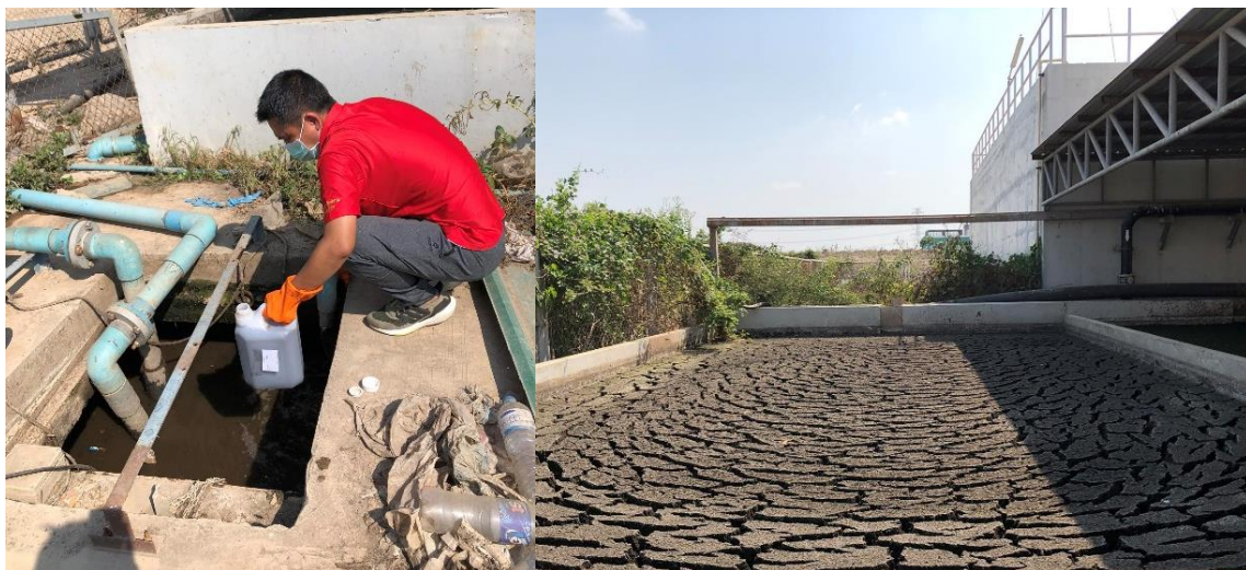
รูปภาพ 2 สุ่มตัวอย่างน้ำทิ้งและกากตะกอน จากระบบบำบัดสิ่งปฏิกูล อำเภอไทรน้อย จังหวัดนนทบุรี (ในวันที่ 27 มีนาคม พ.ศ. 2566)
